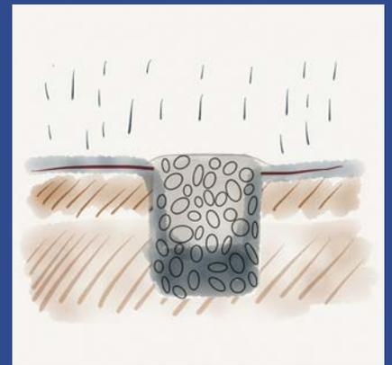
Un elemento de infiltración permite que grandes flujos de agua descendan durante las lluvias y se integren a las napas subterráneas.
