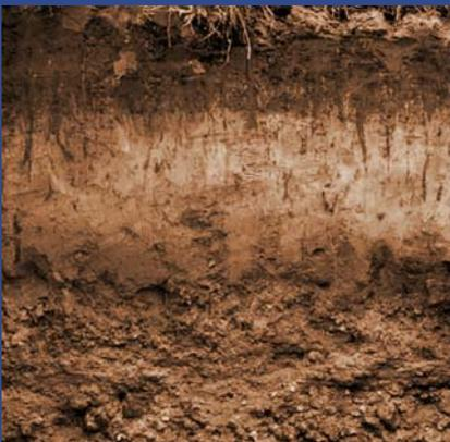
Perfil de suelo típico, donde destaca una zona impermeable cerca de la superficie y más abajo una permeable.
